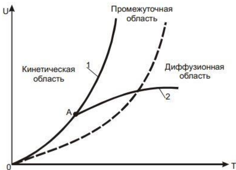
Рисунок 2.4. Зависимость скорости U кинетического (1) и диффузионного (2) режимов от температуры. Точка А – переход из кинетической области в диффузионную.
